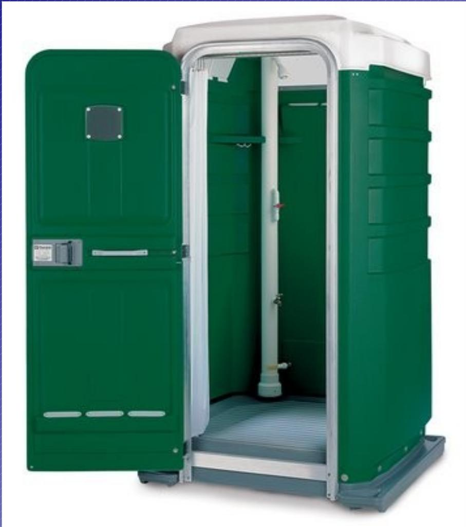
Le système d'eau douce est activé par un clapet à bille et distribue 9,5 litres d'eau par minute. La Fleet eau froide comprend une combinaison robinet intérieur et flexibles. Nécessite pression, source d'eau fraîche et une connexion à un système d'évacuation des eaux usées.
